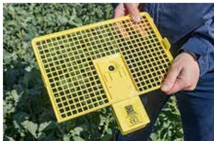
Die Kameralinse am Elektronikmodul schaut senkrecht von oben in die Schale.
